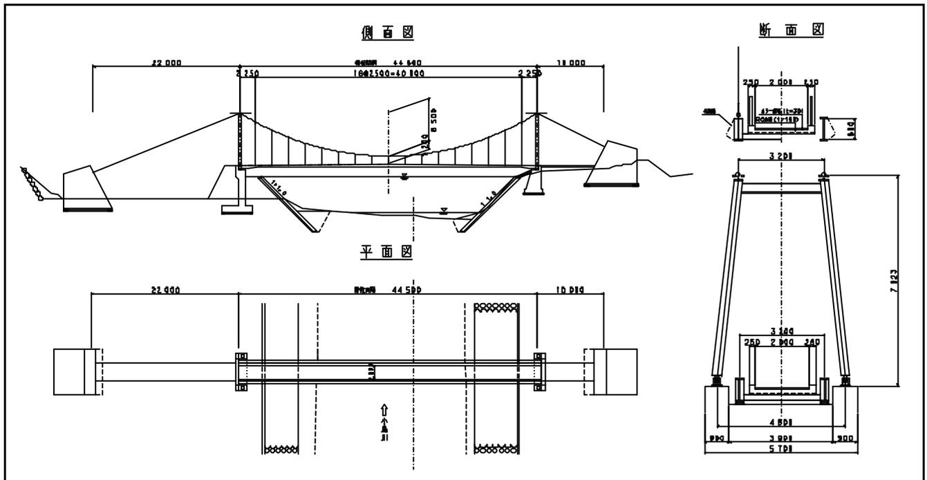
Memo: 本橋梁は、キャンプ場と駐車場の連絡橋として、計画された。村長の意向もあり景観を重視し吊橋を採用した。施工場所が寒冷地であるためプレキャスト床版を使用し工期短縮を図った。橋の中央に設置した虹を作り出す噴水により、キャンプ場を訪れる人々を楽しませる橋梁となった。
